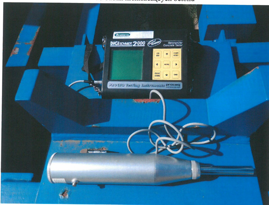
Fot. XIX. Sklerometr Proceq Digi-Schmidt 2000 z rejestratorem elektronicznym – użyty do badań nieniszczących betonu
