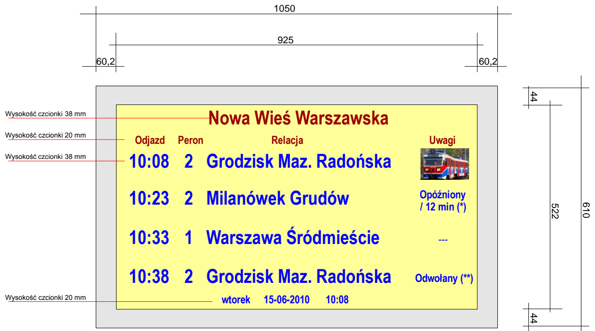
Rys. W-1 Wyświetlacz 42" - wersja "Dzień" / polska
